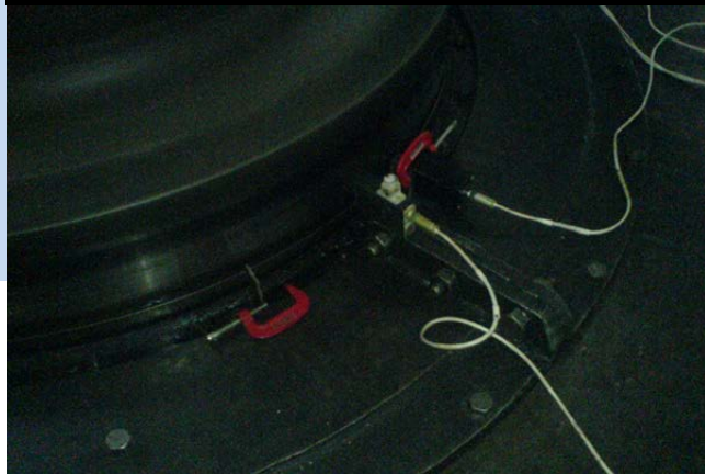
Фотоотметчик и датчик биения ВГП
