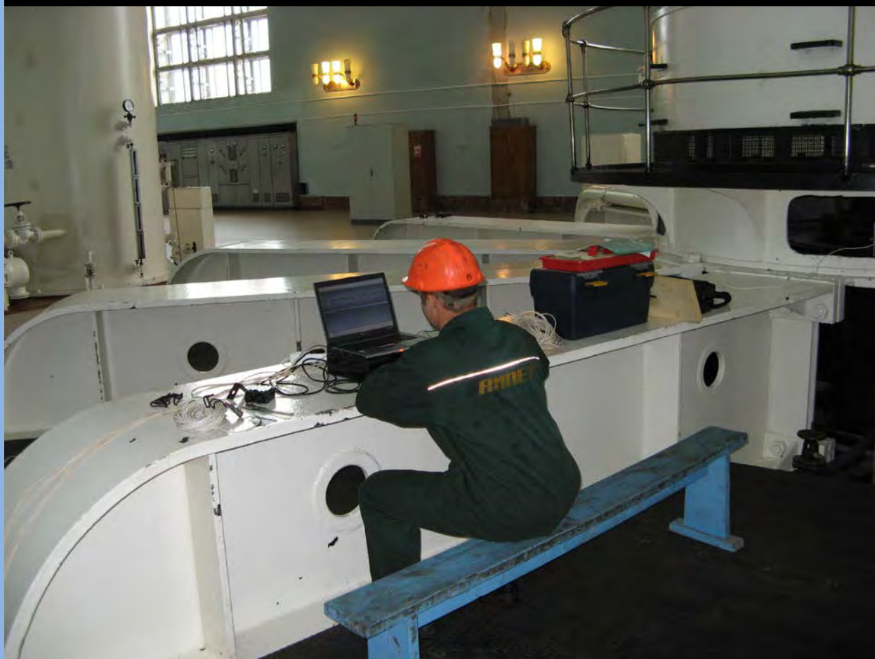
Сбор данных при проведении испытаний
